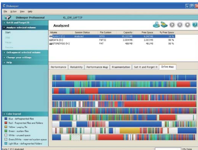
図3 ディスクを4週間使用した後の一般的な断片化パターン
